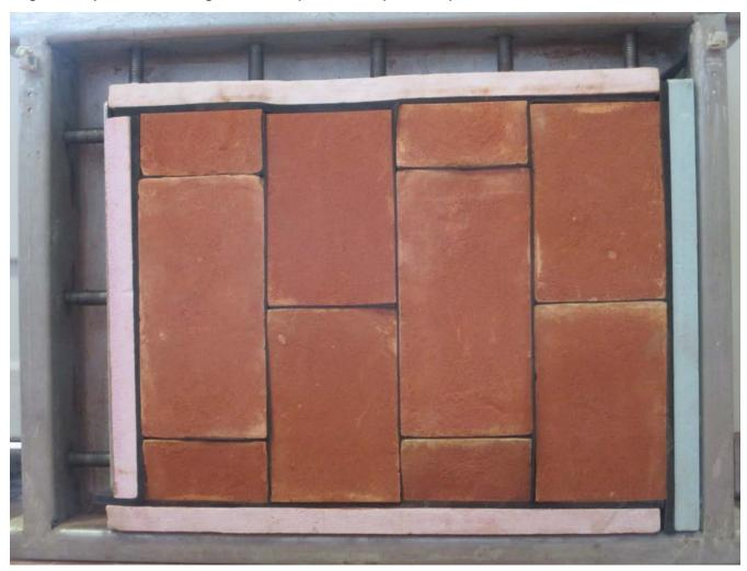
Figura 2. Riproduzione fotografica del pannello composto da 10 elementi (2 interi e 8 ricavati per taglio ad umido da altrettanti campioni interi) del prodotto "Pianella 15x30x2,5 cm Rosso" prima dell'effettuazione della prova di resistenza al gelo/disgelo. Sono visibili il telaio di acciaio inossidabile, i giunti di separazione di gomma e le quattro lastre laterali di polistirene estruso.
