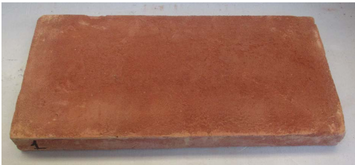
Figura 1. Riproduzione fotografica di un provino tal quale del prodotto "Pianella 15x30x2,5 cm Rosso".
